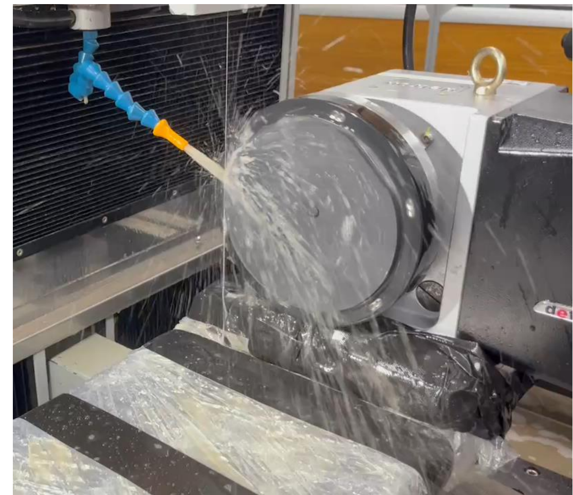
單軸切削晶碲畫面:缺少切片掉落保護機制
